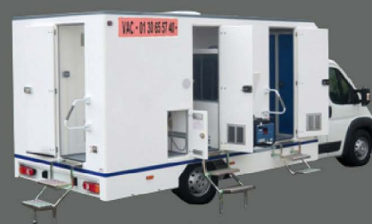
B 5 SAS Base vie de décontamination sur porteur
